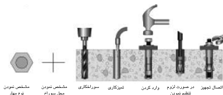
شکل ۵-۱۳۱- مراحل نصب مهارهای غیرچسبنده
