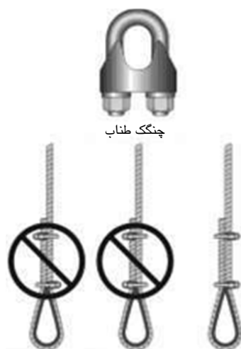
شکل ۵-۱۴۹- روش مناسب چنگک طناب سیمی
